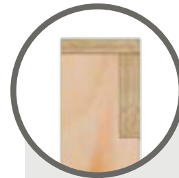
Ausgeklinkerter wandständer mit durchgehendem rähm
